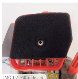
IMG-02: Filtro de aire.
